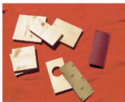
**2** Anschließend sollen alle Holzplatten auf allen Seiten mit dem Schleifpapier glatt geschliffen werden. Achten Sie darauf, dass keine Splitter an den Kanten herausschauen. Daran könnte sich Ihr Hamster sonst verletzen. Auch die Einstiegsöffnung muss geschliffen werden.
