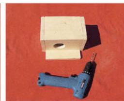
**4** Nachdem der Leim getrocknet ist, fixieren Sie die Deckelplatte auf dem Grundgerüst. In die hinteren oberen Ecken der Seitenplatten bohren Sie mit dem 6-mm-Bohrer jeweils ein 30 mm tiefes Loch hinein; also durch die Seitenplatte durch und noch 10 bis 15 mm tief in den Deckel hinein.
