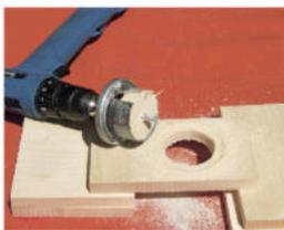
**1** In die zugeschnittene Frontplatte bohren Sie mit der Lochsäge das Einstiegsloch an der gewünschten Stelle hinein. Das sollte einen Durchmesser von mindestens 6 cm haben, damit der Hamster auch noch durchpasst, wenn er seine Backentaschen aufgefüllt hat.
